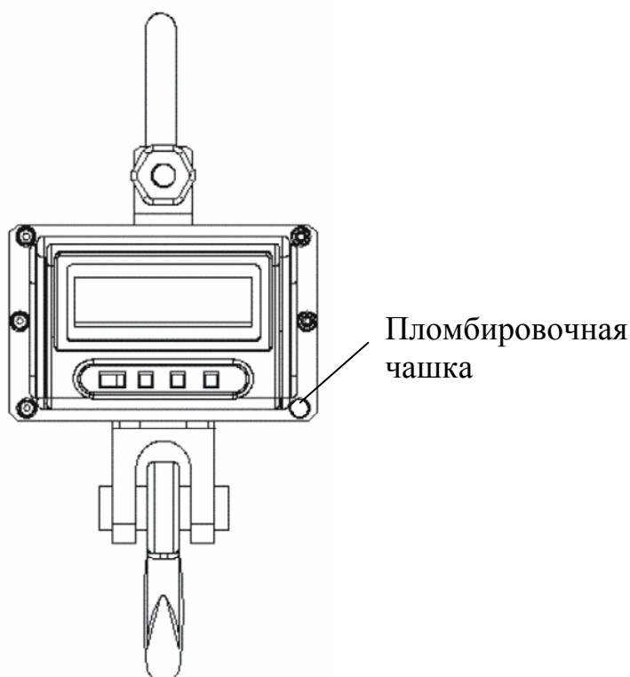
Рис. 16.1 - Место нанесения оттиска поверительного клейма
